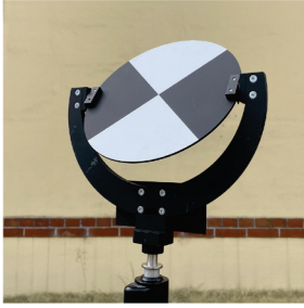
Fig. 6.109: Tilt & turn target (Zoller & Fröhlich).
