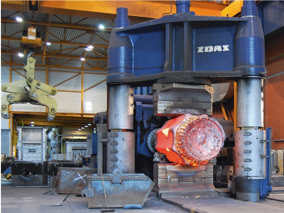
Fig. 5.4 Two-column open die forging press, press force up to 4000 t. (Photo: Schlegel, J., BGH Edelstahl Siegen GmbH)
