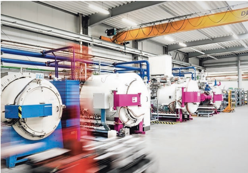
Fig. 6.19 Vacuum hardening facilities and protective gas annealing furnaces. (Photo: G & M Vacuotherm Härterei- und Oberflächentechnik GmbH, Brand-Erbisdorf)
