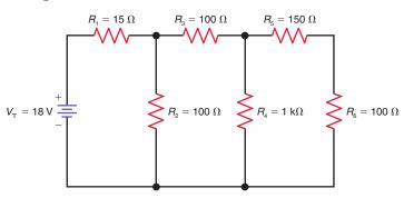
**6–33** In Fig. 6–43, solve for  $I_{\rm T}$ ,  $R_{\rm T}$ ,  $R_{\rm 2}$ ,  $V_{\rm 2}$ ,  $V_{\rm 3}$ ,  $V_{\rm 4}$ ,  $V_{\rm 5}$ ,  $V_{\rm 6}$ ,  $I_{\rm 2}$ ,  $I_{\rm 3}$ ,  $I_{\rm 4}$ ,  $I_{\rm 5}$ , and  $I_{\rm 6}$ .
