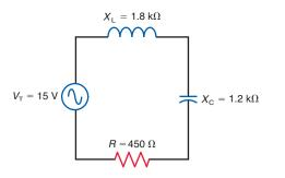
**23–20** In Fig. 23–29, solve for a. the net reactance, X. b.  $Z_{\rm T}$ . c. I. d.  $V_{\rm R_1}$  and  $V_{\rm R_2}$ . e.  $V_{\rm L_1}$  and  $V_{\rm L_2}$ . f.  $V_{\rm C_1}$  and  $V_{\rm C_2}$ . g.  $\theta_{\rm Z}$ .
