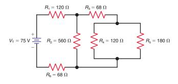
**6–25** In Fig. 6–35, solve for  $R_{\rm T}$ ,  $I_{\rm T}$ ,  $V_{\rm 1}$ ,  $V_{\rm 2}$ ,  $V_{\rm 3}$ ,  $V_{\rm 4}$ ,  $V_{\rm 5}$ ,  $V_{\rm 6}$ ,  $V_{\rm 7}$ ,  $I_{\rm 1}$ ,  $I_{\rm 2}$ ,  $I_{\rm 3}$ ,  $I_{\rm 4}$ ,  $I_{\rm 5}$ ,  $I_{\rm 6}$ , and  $I_{\rm 7}$ .
