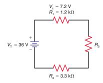
**4-39** In Fig. 4–43, solve for  $R_3$ , I,  $V_{\rm T}$ ,  $V_{\rm 1}$ ,  $V_{\rm 2}$ ,  $V_{\rm 3}$ ,  $V_{\rm 4}$ ,  $P_{\rm 1}$ ,  $P_{\rm 3}$ ,  $P_{\rm 4}$ , and  $P_{\rm T}$ .
