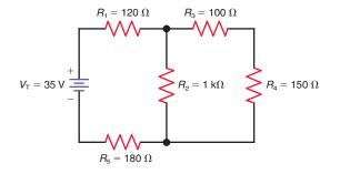
**6–22** In Fig. 6–32, solve for  $R_{\rm T}$ ,  $I_{\rm T}$ ,  $V_{\rm 1}$ ,  $V_{\rm 2}$ ,  $V_{\rm 3}$ ,  $V_{\rm 4}$ ,  $V_{\rm 5}$ ,  $V_{\rm 6}$ ,  $I_{\rm 1}$ ,  $I_{\rm 2}$ ,  $I_{\rm 3}$ ,  $I_{\rm 4}$ ,  $I_{\rm 5}$ , and  $I_{\rm 6}$ .
