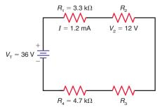
**4-37** In Fig. 4–41, solve for *I*,  $R_{\rm T}$ ,  $V_{\rm T}$ ,  $V_{\rm 2}$ ,  $V_{\rm 3}$ ,  $V_{\rm 4}$ ,  $R_{\rm 4}$ ,  $P_{\rm 1}$ ,  $P_{\rm 2}$ ,  $P_{\rm 3}$ , and  $P_{\rm 4}$ .
