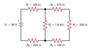
**6–23** In Fig. 6–33, solve for  $R_{\rm T}$ ,  $I_{\rm T}$ ,  $V_{\rm 1}$ ,  $V_{\rm 2}$ ,  $V_{\rm 3}$ ,  $V_{\rm 4}$ ,  $V_{\rm 5}$ ,  $I_{\rm 1}$ ,  $I_{\rm 2}$ ,  $I_{\rm 3}$ ,  $I_{\rm 4}$ , and  $I_{\rm 5}$ .
