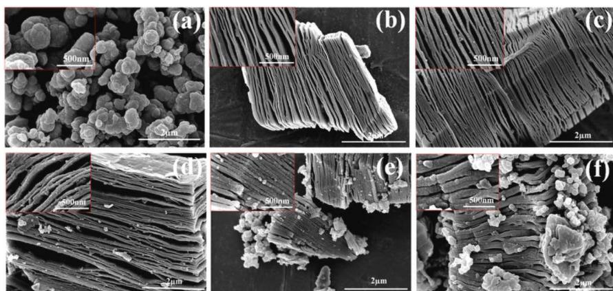
**FIGURE 6.9** SEM images of (a) pure PPy, (b) pure  $\text{Ti}_3\text{C}_2$  MXene, (c)  $\text{Ti}_3\text{C}_2$ /PPy-2, (d)  $\text{Ti}_3\text{C}_2$ /PPy-3, (e)  $\text{Ti}_3\text{C}_2$ /PPy-4, (f)  $\text{Ti}_3\text{C}_2$ /PPy-5.
